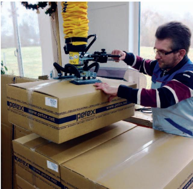
Steuern statt Heben. Mit dem Vakuumheber gelingt das Stapeln von schweren Kartons rückschonend und effizient.
