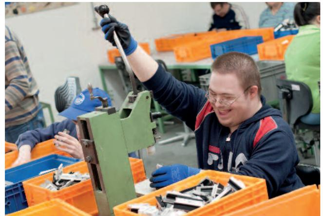
Mit einer Kniehebelpresse werden in der Abteilung Montage Aluminiumprofile bearbeitet.
