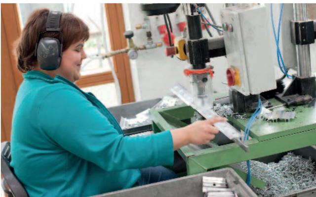
Eine Mitarbeiterin bedient in der Abteilung Metall eine halbautomatische Senkvorrichtung.
